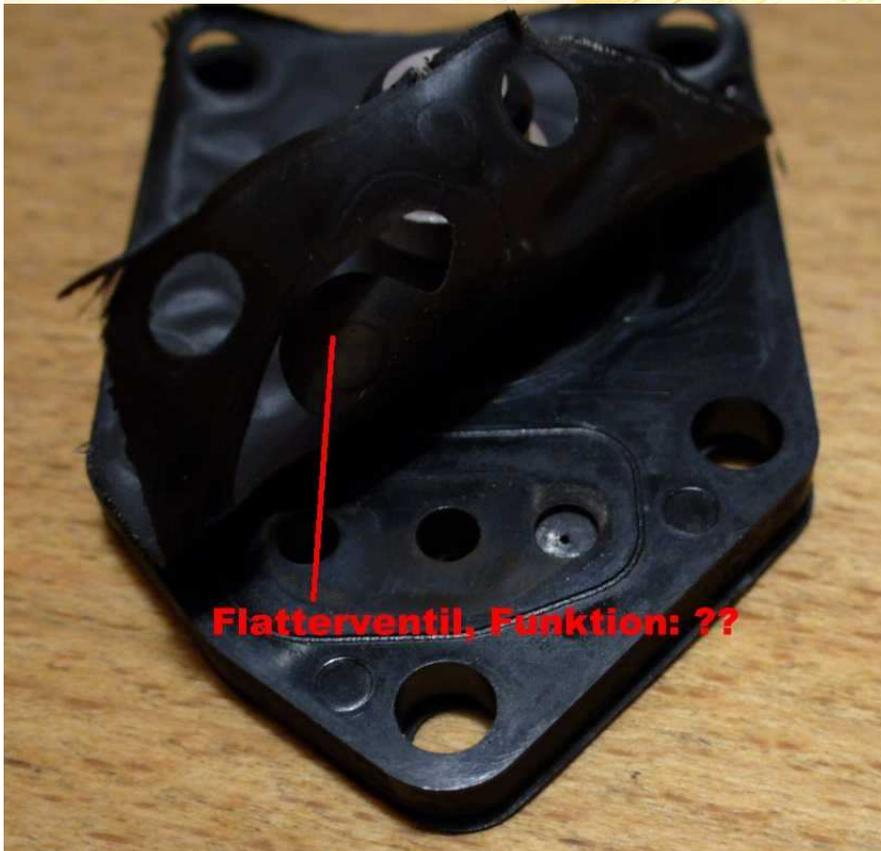
Hier sieht man die 3-geteilte Dichtung, die gleichzeitig auch die Unterdruckmembran und das Flatterventil enthält. Was mich hier besonders irritiert sind die Bohrungen für den Unterdruck, die so gar nicht übereinander liegen und daher teilweise bis zur Hälfte vom Gummi verdeckt werden.
