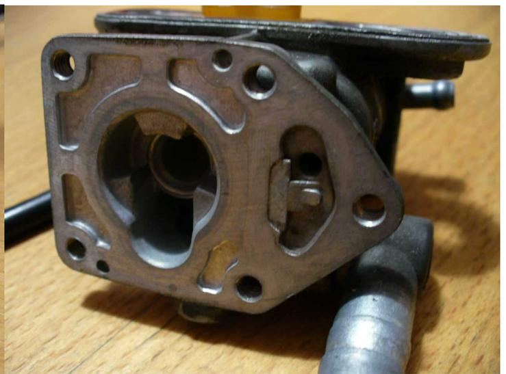
Auf dieser Seite sieht man den eigentlichen Benzinweg, von oben (über das Benzinsieb) durch den Mittelkanal nach unten, rechts durchs Gehäuse in das Rohr zum Benzinschlauch. Abgesperrt wird der Fluß durch den Bolzen mit dem O-Ring im linken Bild.
